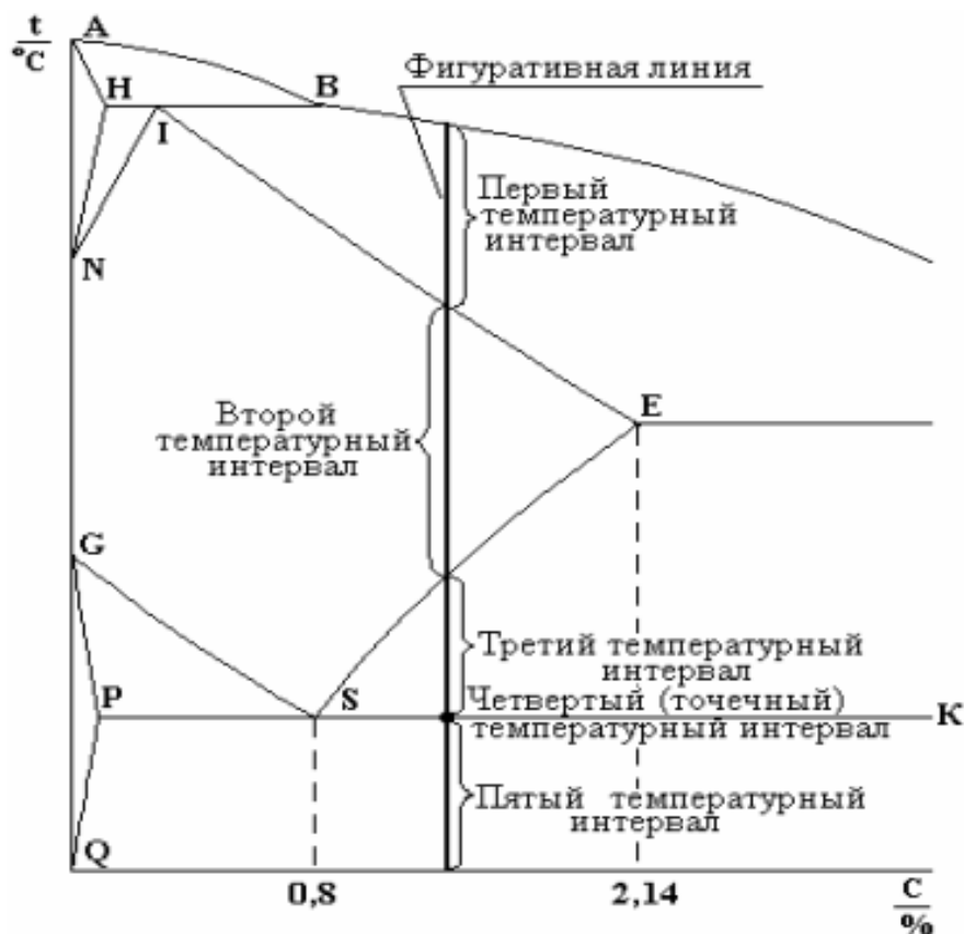
Рис. 2. Пример определения температурных интервалов фазовых превращений
